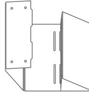
③ Colocar el expositor con el perfil lateral apoyado sobre el suelo y colocar los tornillos según figura.
